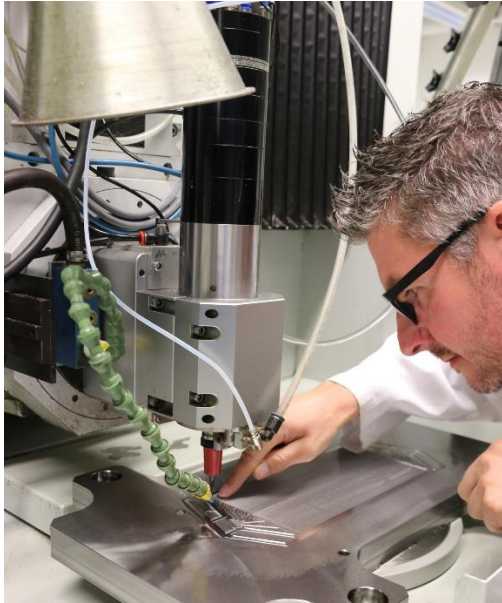
(2) Vorbereitung des Werkzeugs für den Einsatz bei der Bipolarplatten-Fertigung. © Fraunhofer IWU
