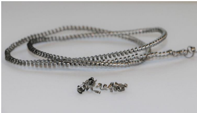
Abb. 4 Mit Schwingungsunterstützung erzeugte kurze Späne (Bildvordergrund) im Vergleich zu langen Spänen (konventioneller Drehprozess mit identischen Parametern) © Fraunhofer IWU www.iwu.fraunhofer.de
