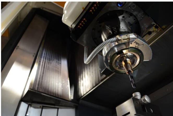
Abb. 2 System für das ultraschallunterstützte Bohren und Tiefbohren © Fraunhofer IWU www.iwu.fraunhofer.de
