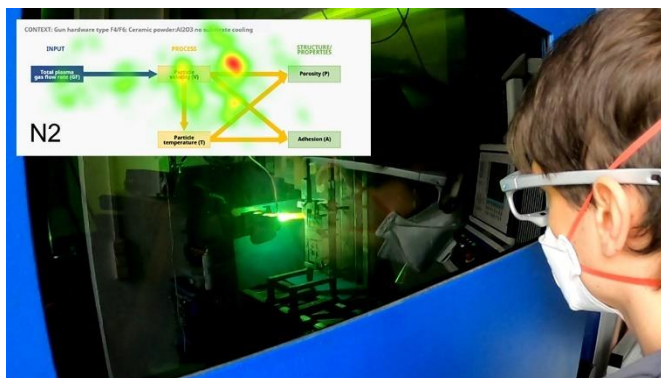
Abb. 2 Bediener bei der Überwachung und Steuerung einer Plasma-Beschichtungsanlage: Hochaufgelöste Daten werden zur Prozessmodellierung mit transparenten KI-Verfahren genutzt. So entsteht ein Cyber-Partner des Menschen bei komplexen Entscheidungen. Die Heatmap visualisiert die Blickverweildauer des Bediener (grün = kurz, rot = lang).
